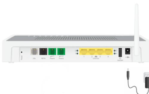
στη συσκευασία στην είσοδο τροφοδοσίας του Router, το άλλο άκρο στην πρίζα ρεύματος και πιέστε το διακόπτη ON/OFF.
